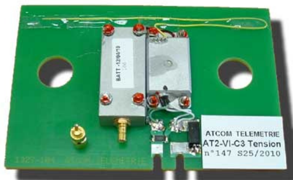
Exemple d'intégration mesure tension 220V, courant 930A
